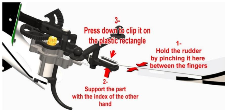
组装方向舵，请用拇指和食指握住方向舵的钢丝部分（1-），将另一只手的食指放在矩形支架部件下（2-）支撑住。然后将方向舵的尾圈按压固定在矩形支架上（3-）。
