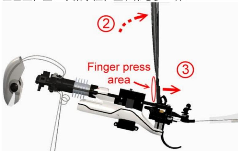
③ - 最大限度地向下移动手指至图示的底部区域（尽量低），向后掰动（和机头相反的方向），尽量柔和发力。
