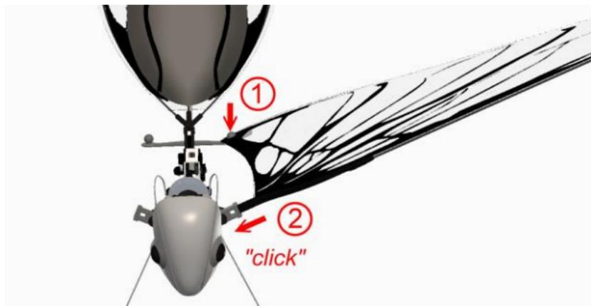
①-在主体后部，将机翼的后部卡入转向机构的圆形凸起中。
