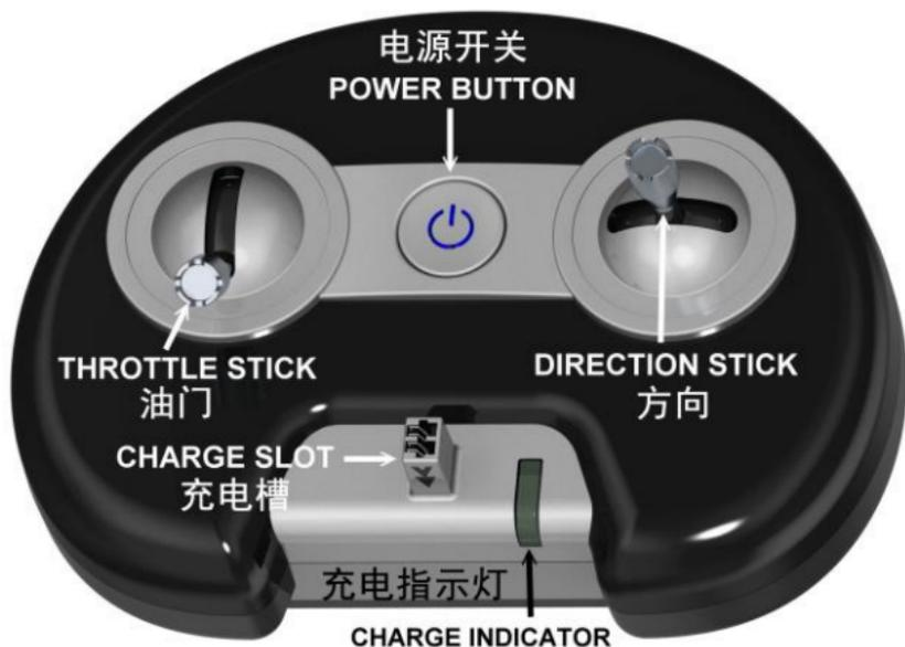
**左操纵杆-油门控制：**此操纵杆控制翅膀拍打的频率，控制 MetaFly 升空的速度。
